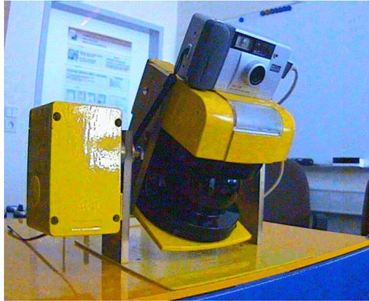
**Abbildung 2.1:** Der Aufbau des 3D Laserscanners. Die Drehachse verläuft horizontal
