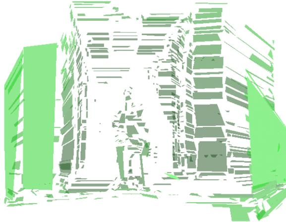
Die erkannten Linien werden zu Flächen zusammengefaßt. Schön zu sehen ist die große Fläche auf der linken Seite. Die Person in der Mitte ist nun als ein lose zusammenhängender Haufen unterschiedlich orientierter, kleinerer Flächen sichtbar.
